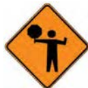
전방 갓발에 의한 교통 통제
