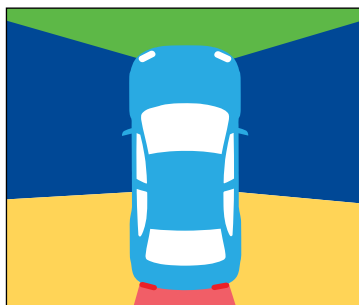
차량 주변을 확인하십시오. 녹색은 전방. 파란색은 차량의 좌우. 노란색은 사각 지대/운전 금지 구역. 빨간색은 후방.
