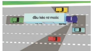
Các khu vực bóng mờ trong hình ảnh này là điểm mù của tài xế xe tải.
